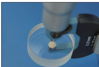
测砧测量面干涉条纹数： N=1 测砧测量面的平面度： 1 \times 0.3 = 0.3 \mu\text{m}
