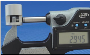
J型测头测量异型零件根部尺寸
