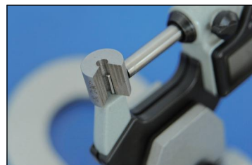
A型测头测量深孔壁厚
