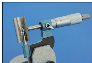
C型测头测量深孔壁厚
