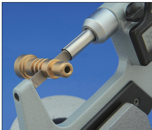
B型测头测量零件槽尺寸
