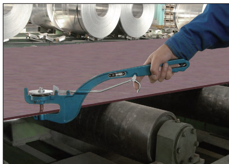
测量热轧板厚度
