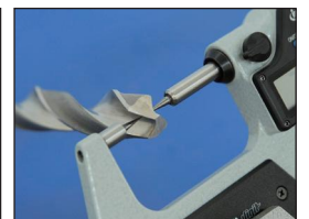
D型测头测量钻头芯厚
