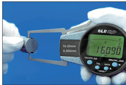
测量键槽根部直径
