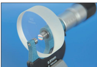
丝杆测量面干涉条纹数： M=2
